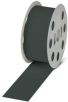
Schrumpfschlauch, Rolle, schwarz, unbeschriftet, beschriftbar mit: THERMOMARK E.300 (D)/600 (D), THERMOMARK ROLLMASTER 300/600, THERMOMARK ROLL X1, THERMOMARK ROLL, THERMOMARK ROLL 2.0, THERMOMARK W, THERMOMARK X1.2, Kabeldurchmesserbereich: 16,9 ... 50,8 mm, unperforiert, Montageart: aufschieben, Anzahl der Einzelschilder: 1, Rollenlänge: 15 m, Textfeldhöhe: 80 mm, Textfeldbreite: 15000 mm
