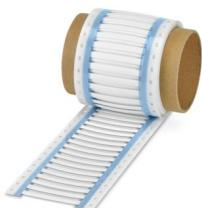
Schrumpfschlauch, Rolle, weiß, unbeschriftet, beschriftbar mit: THERMOMARK E.300 (D)/600 (D), THERMOMARK ROLLMASTER 300/600, THERMOMARK ROLL X1, THERMOMARK ROLL, THERMOMARK ROLL 2.0, THERMOMARK W, THERMOMARK X1.2, Kabeldurchmesserbereich: 1 ... 3,2 mm, unperforiert, Montageart: aufschieben, Anzahl der Einzelschilder: 250, Textfeldhöhe: 5 mm, Textfeldbreite: 60 mm
