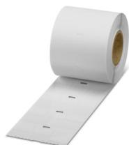
Kabelwickeletikett, Rolle, weiß, unbeschriftet, beschriftbar mit: THERMOMARK E.300 (D)/600 (D), THERMOMARK ROLL 2.0, THERMOMARK ROLL, THERMOMARK ROLL X1, THERMOMARK ROLLMASTER 300/600, THERMOMARK X1.2, Kabeldurchmesserbereich: 4 ... 7,6 mm, Montageart: kleben, Kabeldurchmesser:  $\leq 7,6$  mm, Anzahl der Einzelschilder: 2100, Textfeldhöhe: 12,7 mm, Textfeldbreite: 25,4 mm
