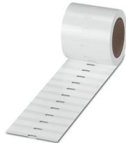
Einsteckschild, zur Kennzeichnung der Inline-Module von Phoenix Contact, Rolle, weiß, unbeschriftet, beschriftbar mit: THERMOMARK E.300 (D)/600 (D), THERMOMARK ROLL 2.0, THERMOMARK ROLL, THERMOMARK ROLL X1, THERMOMARK ROLLMASTER 300/600, THERMOMARK X1.2, Montageart: einschieben, Anzahl der Einzelschilder: 500, Textfeldhöhe: 10 mm, Textfeldbreite: 62 mm
