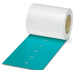
Einsteckschild, zur Kennzeichnung von Siemens Steuerungen S7-300, Rolle, türkis, unbeschriftet, beschriftbar mit: THERMOMARK E.300 (D)/600 (D), THERMOMARK ROLL 2.0, THERMOMARK ROLL, THERMOMARK ROLL X1, THERMOMARK ROLLMASTER 300/600, THERMOMARK X1.2, Montageart: einschieben, Anzahl der Einzelschilder: 500, Textfeldhöhe: 23 mm, Textfeldbreite: 103 mm
