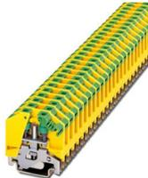
Schutzleiter-Reihenklemme, Nennspannung: 500 V, Nennstrom: 17,5 A, Anzahl der Anschlüsse: 2, Anschlussart: Bolzenanschluss, Befestigungsart: M3, Montageart: NS 35/7,5, NS 35/15, NS 32, Farbe: grün-gelb
