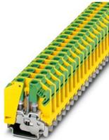
Schutzleiter-Reihenklemme, Anzahl der Anschlüsse: 2, Anschlussart: Bolzenanschluss, Bemessungsquerschnitt: 6 mm<sup>2</sup>, Befestigungsart: M3, Montageart: NS 35/7,5, NS 35/15, NS 32, Farbe: grün-gelb
