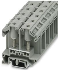
Universalklemme mit Bolzenanschluss, Schlitzschraube, Querschnitt: 1 mm<sup>2</sup> ... 25 mm<sup>2</sup>, Breite: 18 mm, Farbe: grau
