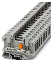
Trennklemme, mit Trennschieber, Nennspannung: 1000 V, Nennstrom: 36 A, Anschlussart: Bolzenanschluss, Bemessungsquerschnitt: 6 mm<sup>2</sup>, Montage: NS 35/7,5, NS 35/15, NS 32, Farbe: grau
