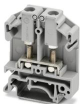
Bolzenanschlussklemme, mit Prüfbuchsen-schrauben zur Aufnahme von Prüfsteckern, Nennspannung: 1000 V, Nennstrom: 41 A, Anzahl der Anschlüsse: 2, Anschlussart: Bolzenanschluss, Bemessungsquerschnitt: 6 mm<sup>2</sup>, Montageart: NS 35/7,5, NS 35/15, NS 32, Farbe: grau
