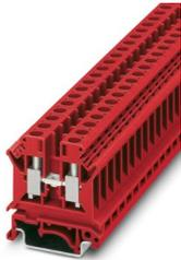
Durchgangsklemme, Nennspannung: 800 V, Nennstrom: 41 A, Anzahl der Anschlüsse: 2, Polzahl: 1, Anschlussart: Schraubanschluss, Bemessungsquerschnitt: 6 mm<sup>2</sup>, Querschnitt: 0,2 mm<sup>2</sup> - 10 mm<sup>2</sup>, Montageart: NS 35/7,5, NS 35/15, Farbe: rot
