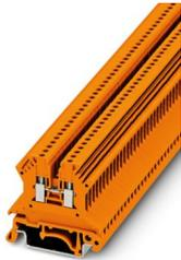
Durchgangsklemme, Nennspannung: 500 V, Nennstrom: 17,5 A, Anzahl der Anschlüsse: 2, Anschlussart: Schraubanschluss, Bemessungsquerschnitt: 1,5 mm<sup>2</sup>, Querschnitt: 0,14 mm<sup>2</sup> - 1,5 mm<sup>2</sup>, Montageart: NS 35/7,5, NS 35/15, NS 32, Farbe: orange
