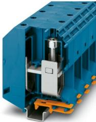
Hochstromklemme, Nennspannung: 1000 V, Nennstrom: 415 A, Anzahl der Anschlüsse: 2, Polzahl: 1, Anschlussart: Schraubanschluss, Bemessungsquerschnitt: 240 mm<sup>2</sup>, Querschnitt: 70 mm<sup>2</sup> - 240 mm<sup>2</sup>, Montageart: NS 35/15, NS 32, Farbe: blau
