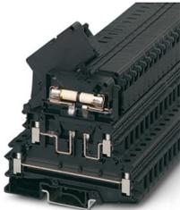
Sicherungsreihenklamm, Art der Sicherung: Glas / Keramik / ..., Sicherungstyp: G / 6,3 x 32, Nennspannung: 400 V, Nennstrom: 6,3 A, Anschlussart: Schraubanschluss, Querschnitt: 0,2 mm<sup>2</sup>- 4 mm<sup>2</sup>, Bemessungsquerschnitt: 1,5 mm<sup>2</sup>, Montageart: NS 35/7,5, NS 35/15, NS 32, Farbe: schwarz
