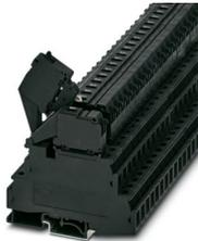
Sicherungsreihenklemme, Art der Sicherung: Glas / Keramik / ..., Sicherungstyp: G / 5 x 20, Nennspannung: 400 V, Nennstrom: 32 A, Anschlussart: Schraubanschluss, Bemessungsquerschnitt: 1,5 mm<sup>2</sup>, Querschnitt: 0,2 mm<sup>2</sup>- 4 mm<sup>2</sup>, Montageart: NS 35/7,5, NS 35/15, NS 32, Farbe: schwarz
