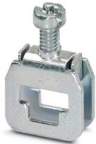
Anschlussklemme, Nennstrom: 32 A, Anschlussart: Schraubanschluss, Bemessungsquerschnitt: 4 mm<sup>2</sup>, Querschnitt: 0,5 mm<sup>2</sup> - 6 mm<sup>2</sup>, Montage: N-Sammelschiene, Farbe: silber
