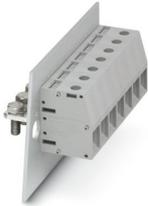
Durchführungsklemme, Anschlussart: Schraubanschluss mit Zughülse, Kabelschuhanschluss, Polzahl: 1, Belastungsstrom: 150 A, Querschnitt: 16 mm<sup>2</sup> - 50 mm<sup>2</sup>, Anschlussrichtung des Leiters zur Steckrichtung: 0 °, Breite: 18,8 mm, Farbe: grau
