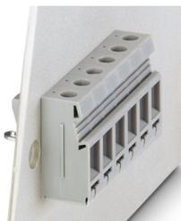
Durchführungsklemme, Anschlussart: Schraubanschluss mit Zughülse, Lötanschluss, Polzahl: 1, Belastungsstrom: 41 A, Querschnitt: 0,2 mm<sup>2</sup> - 10 mm<sup>2</sup>, Anschlussrichtung des Leiters zur Steckrichtung: 0 °, Breite: 10 mm, Farbe: grün-gelb
