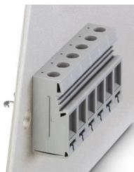
Durchführungsklemme, Anschlussart: Schraubanschluss mit Zughülse, Lötanschluss, Polzahl: 1, Belastungsstrom: 41 A, Querschnitt: 0,2 mm<sup>2</sup> - 10 mm<sup>2</sup>, Anschlussrichtung des Leiters zur Steckrichtung: 0 °, Breite: 10 mm, Farbe: grau
