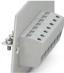
Durchführungsklemme, Anschlussart: Schraubanschluss mit Zughülse, Kabelschuhanschluss, Polzahl: 1, Belastungsstrom: 76 A, Querschnitt: 0,5 mm<sup>2</sup> - 25 mm<sup>2</sup>, Anschlussrichtung des Leiters zur Steckrichtung: 0 °, Breite: 12,1 mm, Farbe: grau
