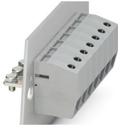
Durchführungsklemme, Anschlussart: Schraubanschluss mit Zughülse, Kabelschuhanschluss, Polzahl: 1, Belastungsstrom: 101 A, Querschnitt: 6 mm<sup>2</sup> - 35 mm<sup>2</sup>, Anschlussrichtung des Leiters zur Steckrichtung: 0 °, Breite: 15 mm, Farbe: grün-gelb
