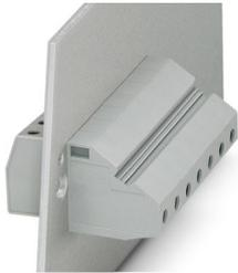
Durchführungsklemme, Anschlussart: Schraubanschluss mit Zughülse, Schraubanschluss mit Zughülse, Polzahl: 1, Belastungsstrom: 57 A, Querschnitt: 0,5 mm<sup>2</sup> - 16 mm<sup>2</sup>, Anschlussrichtung des Leiters zur Steckrichtung: -90 °, Breite: 10,1 mm, Farbe: grau
