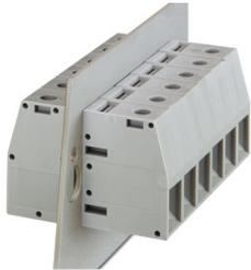
Durchführungsklemme, Anschlussart: Schraubanschluss mit Zughülse, Schraubanschluss mit Zughülse, Polzahl: 1, Belastungsstrom: 150 A, Querschnitt: 16 mm<sup>2</sup> - 50 mm<sup>2</sup>, Anschlussrichtung des Leiters zur Steckrichtung: 0 °, Breite: 18,8 mm, Farbe: grau
