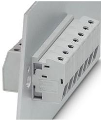
Durchführungsklemme, Anschlussart: Schraubanschluss mit Zughülse, Schraubanschluss mit Zughülse, Polzahl: 1, Belastungsstrom: 57 A, Querschnitt: 0,5 mm<sup>2</sup> - 16 mm<sup>2</sup>, Anschlussrichtung des Leiters zur Steckrichtung: 0 °, Breite: 10,1 mm, Farbe: grau
