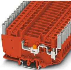
Messwandler-Trennklemme, mit Gleitsteg, Nennspannung: 500 V, Nennstrom: 41 A, Anschlussart: Schraubanschluss, 1. Etage, Bemessungsquerschnitt: 6 mm<sup>2</sup>, Querschnitt: 0,5 mm<sup>2</sup> - 10 mm<sup>2</sup>, Montageart: NS 35/7,5, NS 35/15, NS 32, Farbe: rot
