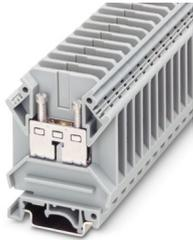
Durchgangsklemme, Nennspannung: 2000 V, Nennstrom: 41 A, Anzahl der Anschlüsse: 2, Anschlussart: Schraubanschluss, Querschnitt: 0,5 mm<sup>2</sup> - 10 mm<sup>2</sup>, Montageart: NS 35/7,5, NS 35/15, NS 32, Farbe: grau
