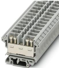
Durchgangsklemme, Nennspannung: 800 V, Nennstrom: 76 A, Anzahl der Anschlüsse: 2, Anschlussart: Schraubanschluss, 1. Etage, Querschnitt: 0,5 mm<sup>2</sup> - 16 mm<sup>2</sup>, Montageart: NS 35/7,5, NS 35/15, NS 32, Farbe: grau
