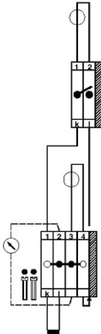
Messwandler-Prüfsatz mit Abgang
