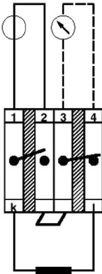
Stromwandler-Prüfschaltung mit Schwenklaschen
