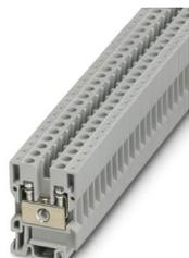
Durchgangsklemme, Nennspannung: 690 V, Nennstrom: 32 A, Anzahl der Anschlüsse: 2, Anschlussart: Schraubanschluss, Querschnitt: 0,2 mm<sup>2</sup> - 4 mm<sup>2</sup>, Montageart: NS 15, Farbe: grau
