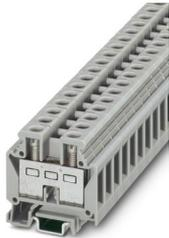
Minidurchgangsklemme, Nennspannung: 500 V, Nennstrom: 41 A, Anzahl der Anschlüsse: 2, Anschlussart: Schraubanschluss, Bemessungsquerschnitt: 6 mm<sup>2</sup>, 1. Etage, Querschnitt: 0,5 mm<sup>2</sup> - 10 mm<sup>2</sup>, Montageart: NS 15, Farbe: grau
