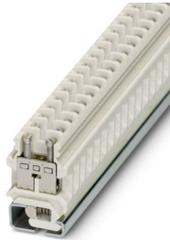
Durchgangsreihenklemme, Anschlussart: Schraubanschluss, Querschnitt: 0,5 mm<sup>2</sup> - 16 mm<sup>2</sup>, AWG 20 - 6, Breite: 10,4 mm, Farbe: weiß, Montageart: NS 32, Isolationsstoff: Keramik
