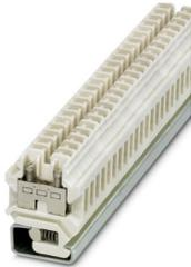
Durchgangsreihenklemme, Anschlussart: Schraubanschluss, Querschnitt:  $0,5 \text{ mm}^2 - 10 \text{ mm}^2$ , AWG 20 - 8, Breite: 8,4 mm, Farbe: weiß, Montageart: NS 32, Isolationsstoff: Keramik
