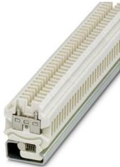
Durchgangsreihenklemme, Anschlussart: Schraubanschluss, Querschnitt: 0,2 mm<sup>2</sup>-4 mm<sup>2</sup>, AWG 24-12, Breite: 6,2 mm, Farbe: weiß, Montageart: NS 32, Isolationsstoff: Keramik
