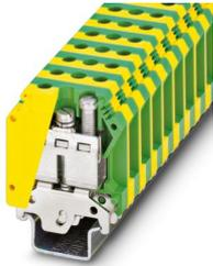
Schutzleiter-Reihenklemme, Für Anschlussquerschnitte  $\geq 35 \text{ mm}^2$  / AWG 2 ist eine Cu-Tragschiene NS 35/15-2,3 einzusetzen! Bei Anreihung an konturgleiche Durchgangsklemme muss bei Isolationsspannungen  $> 690 \text{ V}$  ein Deckel eingesetzt werden, Anzahl der Anschlüsse: 2, Polzahl: 1, Anschlussart: Schraubanschluss, Querschnitt:  $0,75 \text{ mm}^2 - 50 \text{ mm}^2$ , Befestigungsart: PE-Fuß mit Befestigungsschraube, M5, Montageart: NS 35/15-2,3, Farbe: grün-gelb
