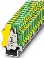
Schutzleiter-Reihenklemme, Anzahl der Anschlüsse: 2, Polzahl: 1, Anschlussart: Schraubanschluss, Querschnitt: 0,5 mm<sup>2</sup> - 16 mm<sup>2</sup>, Montageart: NS 35/15-2,3, Farbe: grün-gelb
