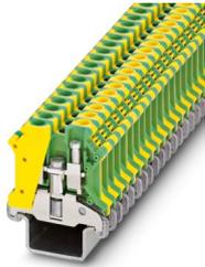
Schutzleiter-Reihenklemme, Anzahl der Anschlüsse: 2, Polzahl: 1, Anschlussart: Schraubanschluss, Querschnitt: 0,2 mm<sup>2</sup> - 10 mm<sup>2</sup>, Befestigungsart: PE-Fuß mit Befestigungsschraube, M4, Montageart: NS 35/15-2,3, Farbe: grün-gelb
