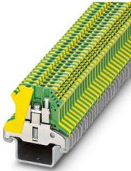
Schutzleiter-Reihenklemme, Anzahl der Anschlüsse: 2, Polzahl: 1, Anschlussart: Schraubanschluss, Querschnitt: 0,2 mm<sup>2</sup> - 4 mm<sup>2</sup>, Befestigungsart: PE-Fuß mit Befestigungsschraube, M2,5, Montageart: NS 35/15-2,3, Farbe: grün-gelb
