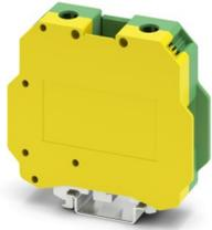
Schutzleiter-Reihenklemme, mit Innensechskantschrauben, Anzahl der Anschlüsse: 2, Polzahl: 1, Anschlussart: Schraubanschluss, Bemessungsquerschnitt: 50 mm<sup>2</sup>, Querschnitt: 16 mm<sup>2</sup> - 50 mm<sup>2</sup>, Befestigungsart: PE-Fuß mit Befestigungsschraube, M6, Montageart: NS 35/7,5, NS 35/15, NS 32, Farbe: grün-gelb
