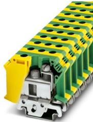
Installations-Schutzleiterklemme, Für Anschlussquerschnitte 35 mm<sup>2</sup> / AWG 2 ist eine Cu-Tragschiene NS 32... oder NS 35... einzusetzen!, Nennspannung: 800 V, Nennstrom: 125 A, Anzahl der Anschlüsse: 2, Polzahl: 1, Querschnitt: 0,75 mm<sup>2</sup> - 35 mm<sup>2</sup>, Befestigungsart: PE-Fuß mit Befestigungsschraube, M5, Montageart: NS 35/7,5, NS 35/15, NS 32, Farbe: grün-gelb
