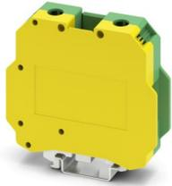
Schutzleiter-Reihenklemme, Anzahl der Anschlüsse: 2, Polzahl: 1, Anschlussart: Schraubanschluss, Bemessungsquerschnitt: 50 mm<sup>2</sup>, Querschnitt: 16 mm<sup>2</sup> - 50 mm<sup>2</sup>, Befestigungsart: PE-Fuß mit Befestigungsschraube, M6, Montageart: NS 35/7,5, NS 35/15, NS 32, Farbe: grün-gelb
