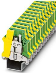
Schutzleiter-Reihenklemme, Bei Anreihung an konturgleiche Durchgangsklemme muss bei Isolationsspannungen > 690 V ein Deckel eingesetzt werden, Anzahl der Anschlüsse: 2, Polzahl: 1, Anschlussart: Schraubanschluss, Bemessungsquerschnitt: 16 mm<sup>2</sup>, Querschnitt: 2,5 mm<sup>2</sup> - 25 mm<sup>2</sup>, Befestigungsart: PE-Fuß mit Befestigungsschraube, M4, Montageart: NS 35/15-2,3, Farbe: grün-gelb
