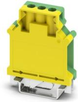
Schutzleiter-Reihenklemme, Bei Anreihung an konturgleiche Durchgangsklemme muss bei Isolationsspannungen > 690 V ein Deckel eingesetzt werden, Anzahl der Anschlüsse: 2, Polzahl: 1, Anschlussart: Schraubanschluss, Bemessungsquerschnitt: 16 mm<sup>2</sup>, Querschnitt: 2,5 mm<sup>2</sup> - 25 mm<sup>2</sup>, Befestigungsart: PE-Fuß mit Befestigungsschraube, M4, Montageart: NS 35/7,5, NS 35/15, NS 32, Farbe: grün-gelb
