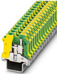
Schutzleiter-Reihenklemme, Anzahl der Anschlüsse: 2, Polzahl: 1, Anschlussart: Schraubanschluss, Bemessungsquerschnitt: 10 mm<sup>2</sup>, Querschnitt: 0,5 mm<sup>2</sup> - 16 mm<sup>2</sup>, Befestigungsart: PE-Fuß mit Befestigungsschraube, M4, Montageart: NS 35/15-2,3, Farbe: grün-gelb
