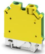
Schutzleiter-Reihenklemme, Anzahl der Anschlüsse: 2, Polzahl: 1, Anschlussart: Schraubanschluss, Querschnitt: 0,2 mm<sup>2</sup> - 10 mm<sup>2</sup>, Befestigungsart: PE-Fuß mit Befestigungsschraube, M4, Montageart: NS 35/7,5, NS 35/15, NS 32, Farbe: grün-gelb
