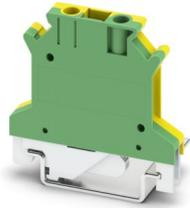
Schutzleiter-Reihenklemme, Anzahl der Anschlüsse: 2, Polzahl: 1, Anschlussart: Schraubanschluss, Querschnitt: 0,2 mm<sup>2</sup> - 4 mm<sup>2</sup>, Befestigungsart: PE-Fuß mit Befestigungsschraube, M3, Montageart: NS 35/7,5, NS 35/15, NS 32, Farbe: grün-gelb
