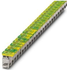
Anschlussklemme, Nennspannung: 300 V, Nennstrom: 125 A, Anschlussart: Schraubanschluss, Bemessungsquerschnitt: 35 mm<sup>2</sup>, Querschnitt: 2,5 mm<sup>2</sup> - 35 mm<sup>2</sup>, Montage: N-Sammelschiene, Farbe: grün-gelb
