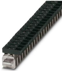
Anschlussklemme, Nennspannung: 300 V, Nennstrom: 41 A, Anschlussart: Schraubanschluss, Bemessungsquerschnitt: 4 mm<sup>2</sup>, Querschnitt: 0,5 mm<sup>2</sup> - 6 mm<sup>2</sup>, Montage: N-Sammelschiene, Farbe: schwarz
