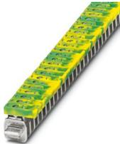
Anschlussklemme, Nennspannung: 300 V, Nennstrom: 41 A, Anschlussart: Schraubanschluss, Bemessungsquerschnitt: 4 mm<sup>2</sup>, Querschnitt: 0,5 mm<sup>2</sup> - 6 mm<sup>2</sup>, Montage: N-Sammelschiene, Farbe: grün-gelb
