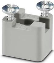
Auflagebock aus Isolierstoff mit 2 Halteschrauben, wahlweise verwendbar für Sammelschiene 3 x 10 mm oder 6 x 6 mm, Farbe: grau
