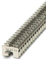
Einspeiseklemme, Nennstrom: 101 A, Anschlussart: Schraubanschluss, Bemessungsquerschnitt : 25 mm<sup>2</sup>, Querschnitt: 0,75 mm<sup>2</sup> - 35 mm<sup>2</sup>, Montage: N-Sammelschiene, Farbe: aluminiumfarben
